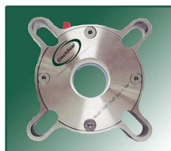
7800系列轴端密封可适应一定程度的轴振动、不对中和摆动等。内部组件在壳体内可以上下浮动，因此可承受一定的轴跳动和偏心，设计承受任意方向3mm的轴跳动。
