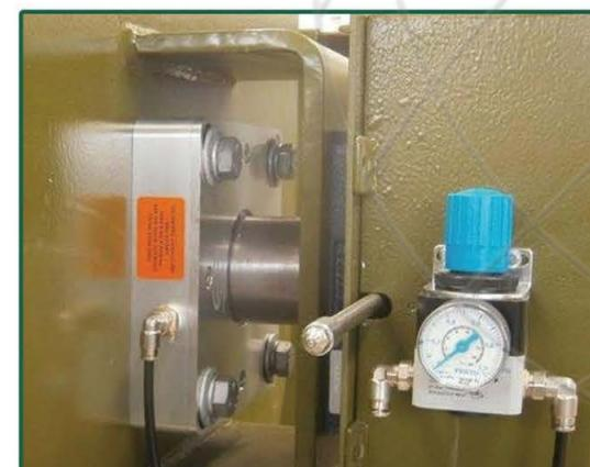
7500系列轴端密封，无论外形尺寸还是螺栓安装方式，都便于替换传统填料密封。使用Cinchseal轴端密封，让您的旋转设备彻底告别粉尘泄漏。
